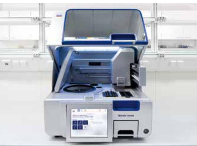
QIAcube Connect は、核酸及びタンパク質のサンプル処理で使う QIAGEN スピнкаラムの溶解、結合、洗浄、溶出ステップを自動化することができます。また対応するキットは 80 以上、必要に応じてカスタムプロトコールもご利用いただけます。
