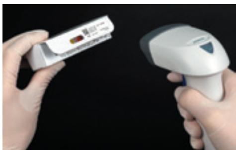
図2. 2次元バーコードによる試薬管理
